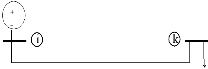
Figura 2.4. Diagrama unifilar de un sistema de transmisión típico
